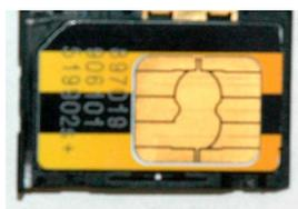
Вставьте слот с SIM картой в гнездо и нажмите на него до фиксации в модеме
