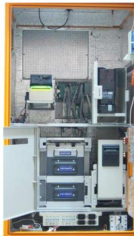
В корпусе автоматической кассы размещены: узел электроники, жетоноприёмник, купюроприёмник, монетоприёмник, диспенсер купюр и хоппер монет для выдачи сдачи, фискальный регистратор, GSM модем, лоток выдачи сдачи, узел блоков питания, источник бесперебойного питания, система климат-контроля, плата аудио
