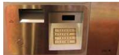
Считыватель банковских карт расположен в верхней части модуля и используется для считывания информации с карт. Pin клавиатура используется для ввода pin кода. Контроллер Uniteller расположен за pin клавиатурой, он управляет считывателем банковских карт, бесконтактным считывателем банковских карт и карт «Тройка», получает информацию с pin клавиатуры, выполняет все необходимые процедуры для проведения оплаты, обменивается информацией с контроллером автоматической кассы по Ethernet.
